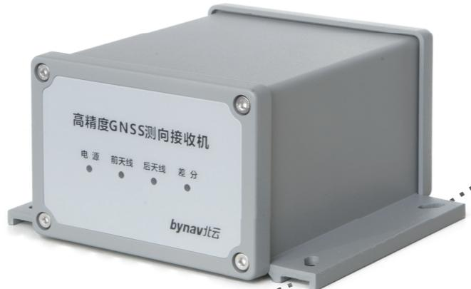
BY352T 车载高精度定位定向整机内置 BY352 高精度定位定向板卡，采用北云科技自主知识产权的快速载波相位模糊度解算技术和多径抑制算法，能够快速精确的解算出两个天线相对位置信息和两个天线相位中心连线与真北之间的夹角（方位角）。集成 MEMS 陀螺仪、加速度计和气压计，使得动态性能更加稳健。同时，通过接收地面基准站差分数据链，可实现实时载波相位差分定位（RTK），为载体提供厘米级的高精度位置信息。
